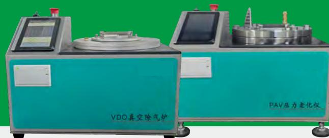
Superpave PG沥青性能试验规范正是根据3个阶段的特点来分别测试其路用性能，从而确定沥青的性能等级。例如：通过3个阶段的沥青流变试验来确定沥青的流变性能曲线，测试第1阶段（未老化）原样沥青的黏度，闪点来确保其具有足够的流动性进行泵送和拌和，不会发生燃烧；测试第3阶段（长期老化）沥青的高低温流变性能，来评价其在长期服役过程中抵抗高温车辙、疲劳开裂和低温开裂的性能。
